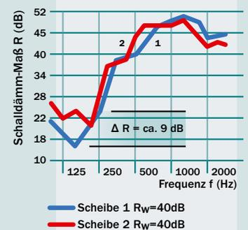
Es wird empfohlen immer auch die Schalldämmkurven der Verglasung zu beachten. Gläser mit gleichem bewertetem Schalldämm-Maß können sehr unterschiedliche schalltechnische Eigenschaften haben (siehe Beispiel). Die Schalldämmung von Glas 2 ist bei einer Frequenz von 125 Hz - also im Bereich maximalen Verkehrslärms - fast doppelt so gut wie die von Glas 1.
